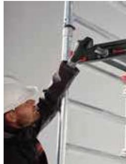
„Zusätzliche Haken“ zum Aufhängen der Gerüstbauteile beim Auf- und Abbau des MiTOWER Fahrgerüst. In nur einer schnellen Bewegung ein- und auszuschieben.
