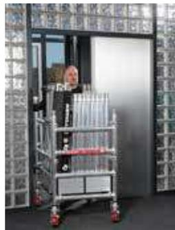
Aus den Gerüstbauteilen kann schnell ein Wagen zusammengestellt werden. Passt durch jede gängige Türöffnung und in viele Firmenwagen.
